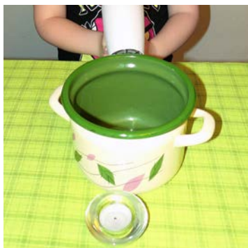
Udana próba gaszenia płomienia świecy ukrytej za naczyniem o dużej średnicy – za pomocą suszarki (S.S.)
