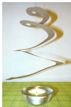
Spirala obracająca się pod wpływem prądu wznoszącego (S.S.)
