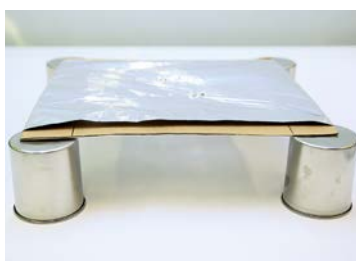
Rozstawienie kubków i ułożenie na nich ramki obłożonej folią (S.Ł.)
