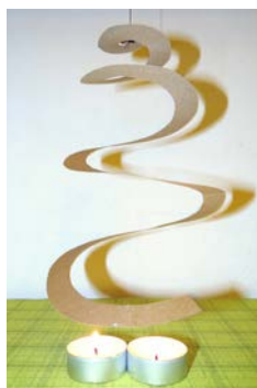
Zwiększenie natężenia konwekcji dzięki wykorzystaniu wielu źródeł ciepła (S.S.)
