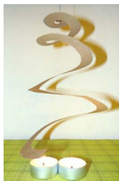
Zwiększenie natężenia konwekcji dzięki wykorzystaniu wielu źródeł ciepła (S.S.)
