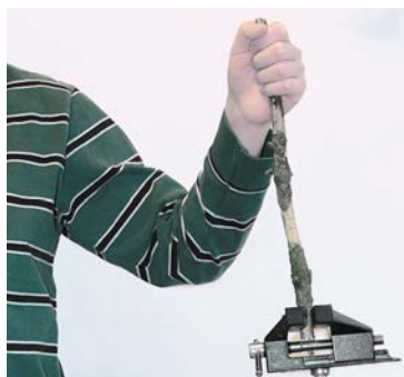
Próba złamania patyka zamocowanego w imadle, uchwyconego z dala od punktu mocowania (A.C.)
