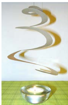
Spirala obracająca się pod wpływem prądu wznoszącego (S.S.)
