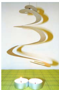
Zwiększenie natężenia konwekcji dzięki wykorzystaniu wielu źródeł ciepła (S.S.)
