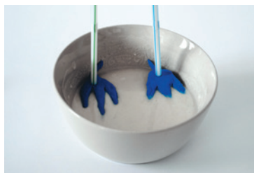
Modele nóg czapli w kontakcie z podłożem bagiennym (P.S.)
