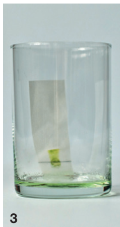
Pasek bibuły z naniesioną kroplą soku z liści – przed chromatografią (1), podczas chromatografii (2), po chromatografii (3) (P.S.)
