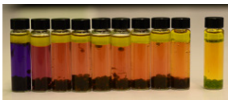
Przygotowanie roztworów wzorcowych wskaźnika poziomu wodorowęglanów (S.L.)
