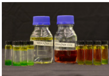
Dodawanie do butelek roztworu wskaźnika wodorowęglanów i tlenu (S.Ł.)
