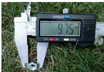
Mierzenie nakrętki suwmiarką (S.S.)
