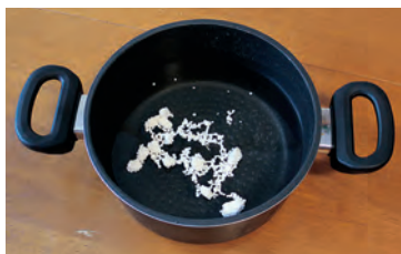
Okruchy styropianu pływające w wodzie (A.C.)
